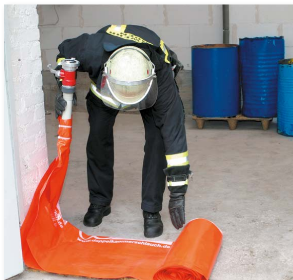
Die Torabdichtung PE wird aus der Transportkiste oder dem Wandschrank entnommen und an der zu schützenden Stelle ausgelegt.
